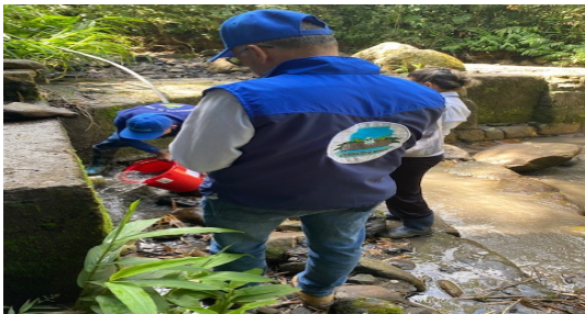
Foto 16: Aforo de Caudal Área de Captación
